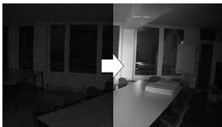
Bei schlechten Lichtbedingungen, zum Beispiel nachts, schaltet die Kamera automatisch in den Schwarz/Weiß-Betrieb um. Die Sicht wird zusätzlich durch die integrierte Infrarotbeleuchtung unterstützt. Die Kamera besitzt einen eingebauten Infrarot-Sperfilter (IR-Cut-Filter). Damit werden störende Einflüsse der IR-Strahlung auf die Abbildungsqualität des Sensors vermieden.
